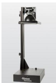
Figure 2 : Appareil de mesure développé par Sinton Instruments 1
