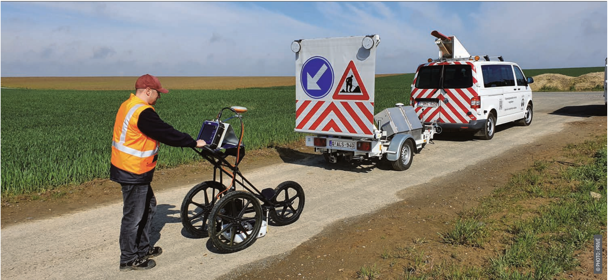
Equipée de capteurs permettant de récolter des données objectives sur les caractéristiques d'un revêtement, cette chaise de mesure aidera à mettre en place des revêtements piétons de qualité.
